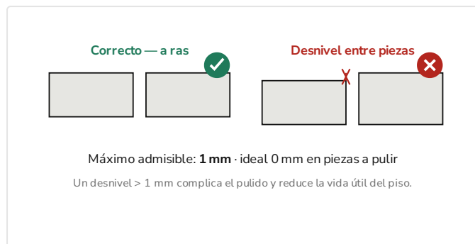
Figura 8. Desnivel: diferencia de altura entre baldosas contiguas.
