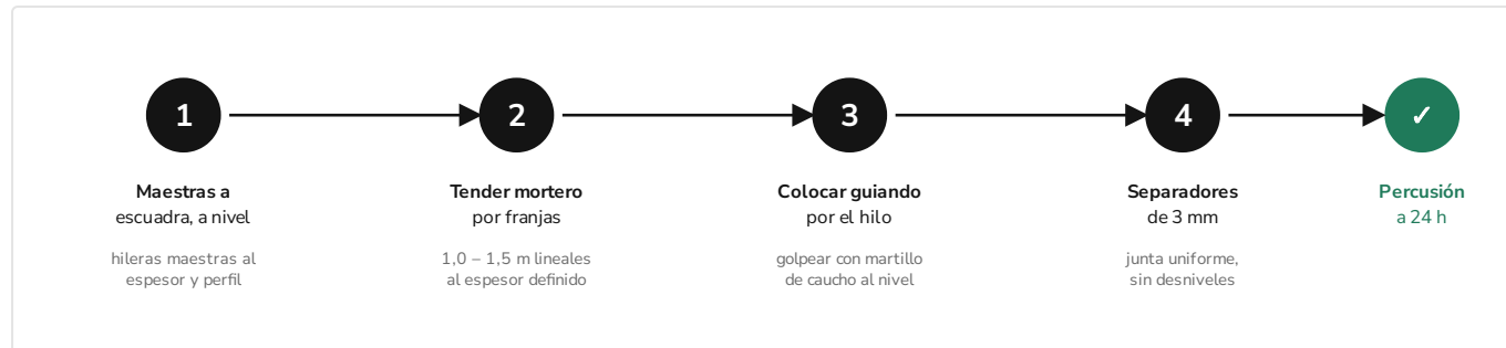
Figura 6. Secuencia de instalación. Nunca instale sin las hileras maestras y niveles definidos.
